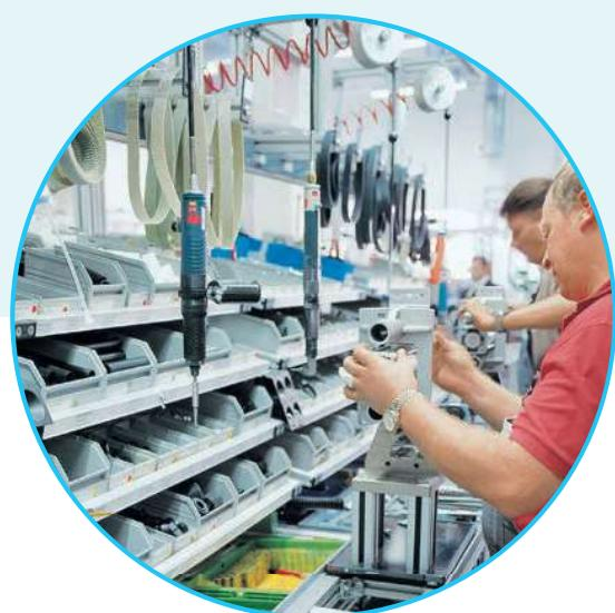
Les clips de marquage, disponibles comme accessoires, permettent d'identifier visuellement les contenus des bacs. La fixation de bacs et le rayonnage à bacs facilitent la mise à disposition des bacs de préhension en plastique.
